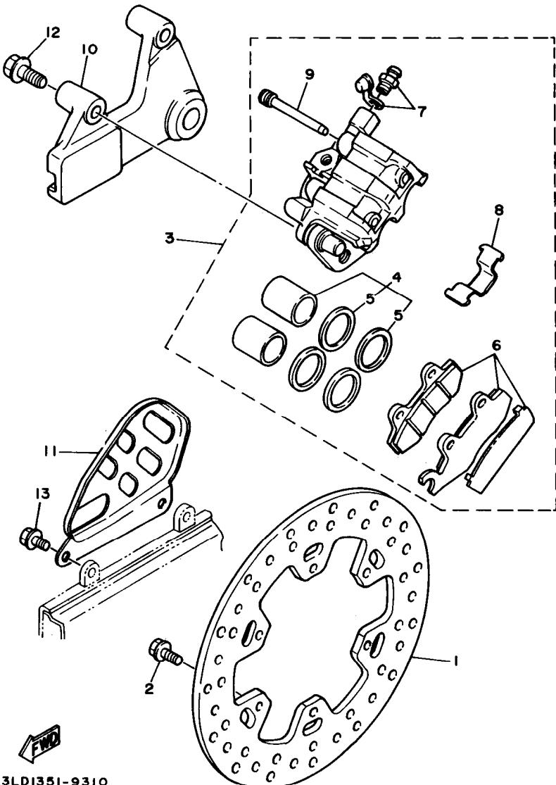
FIG. 31 CALIBRE FRENO TRASERA
