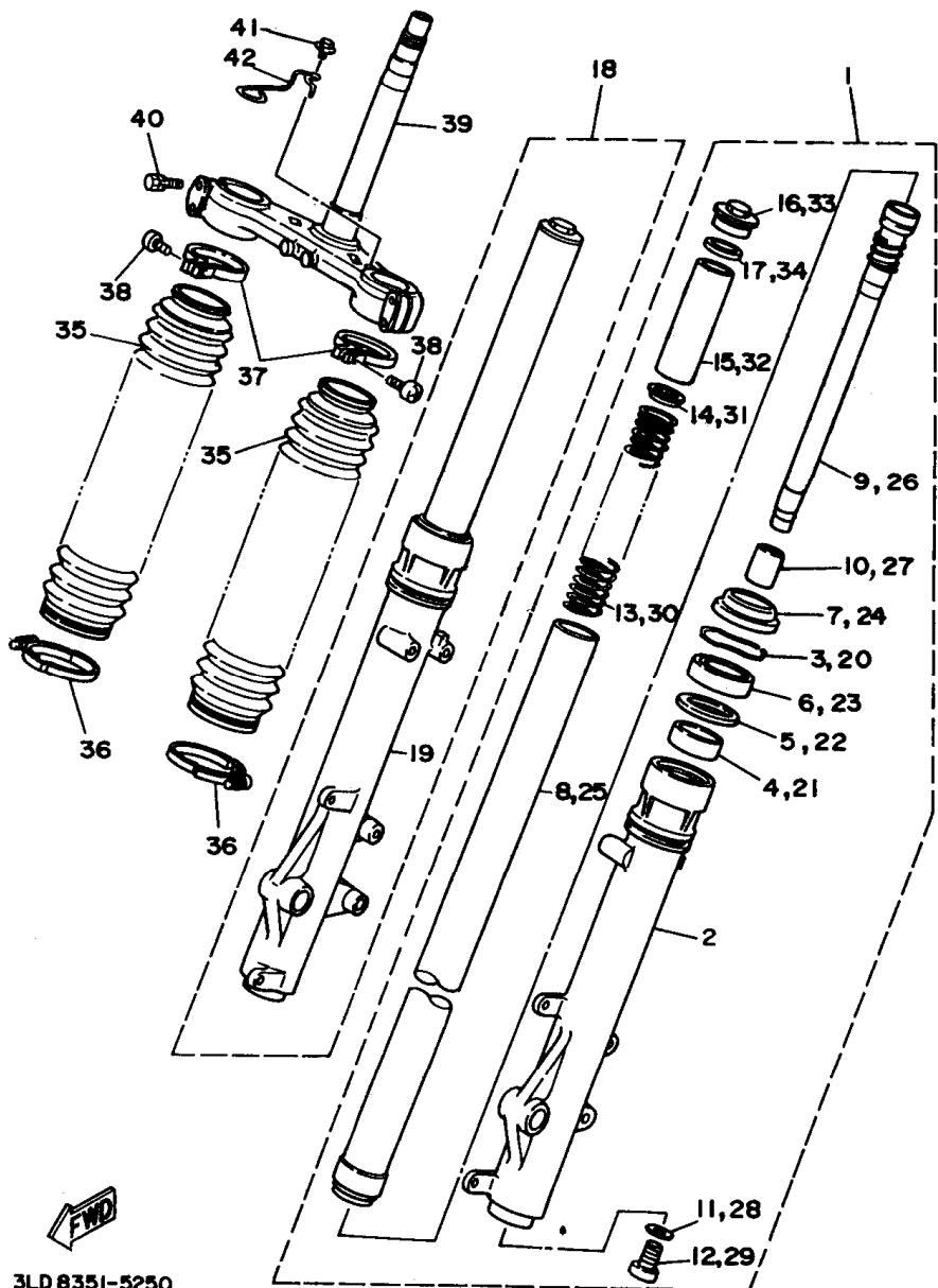
FIG. 25 HORQUILLA DELANTERA
